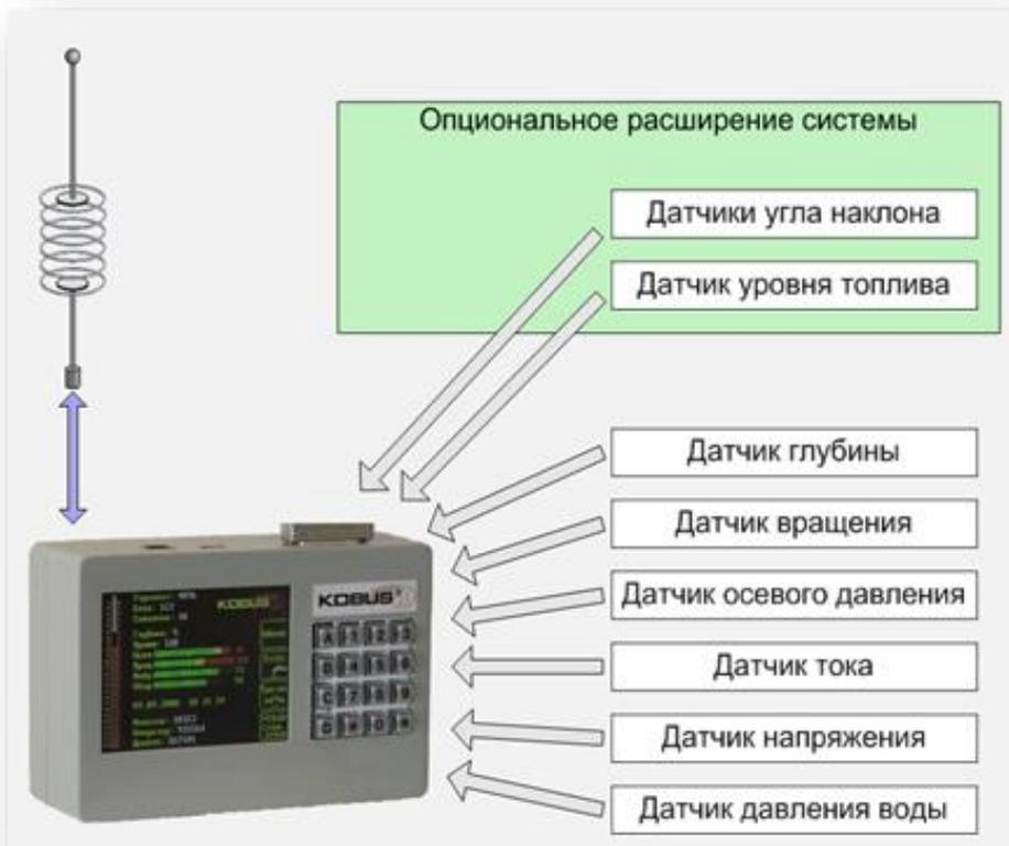
Аппаратный учет количества пробуренных метров и скважин по каждому буровому станку
