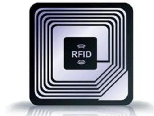
Пассивных меток, размещаемых в касках или фонарях работников, занятых в технологическом процессе.
